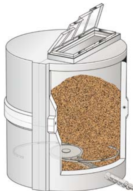
Die unterirdisch eingebauten Stahlbetonbehälter können bei einem maximalen Nutzvolumen von 120 Kubikmetern bis zu 24 Tonnen Hackschnitzel aufnehmen
