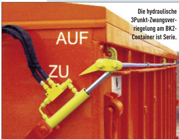
Die hydraulische 3Punkt-Zwangsverriegelung am BK2-Container ist Serie.
