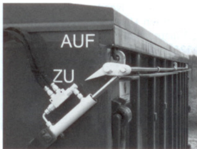
Abb. 2: Die hydraulische 3-Punkt-Zwangsverriegelung am BK-2-Container ist beim Hersteller in Groß Ippener Serie.
